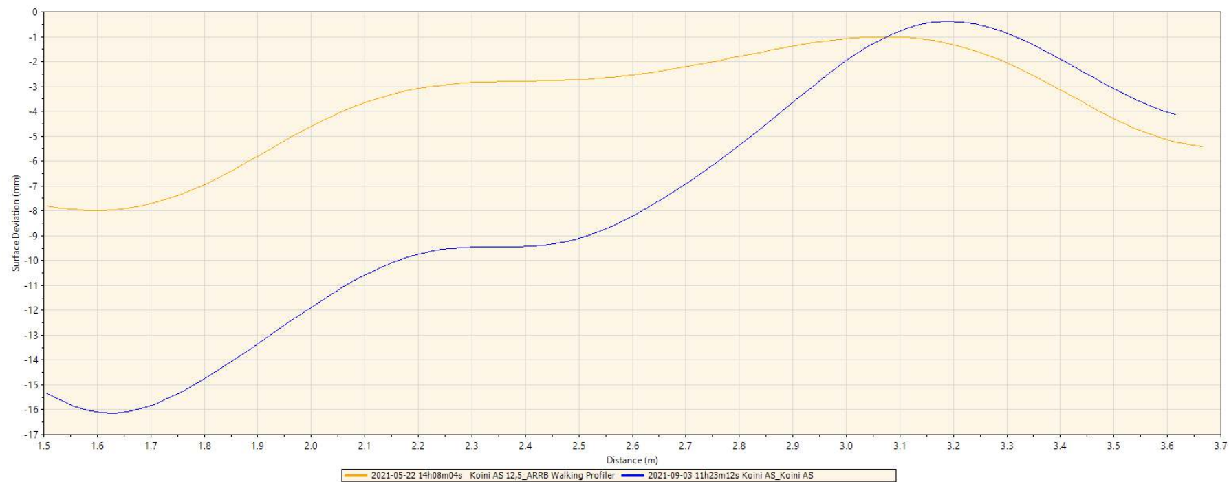
Εικόνα 28- Τροχοαυλάκωση, ΣΥΜΒΑΤΙΚΗ ΑΣΦΑΛΤΟΣ - Σύγκριση αποτελεσμάτων
