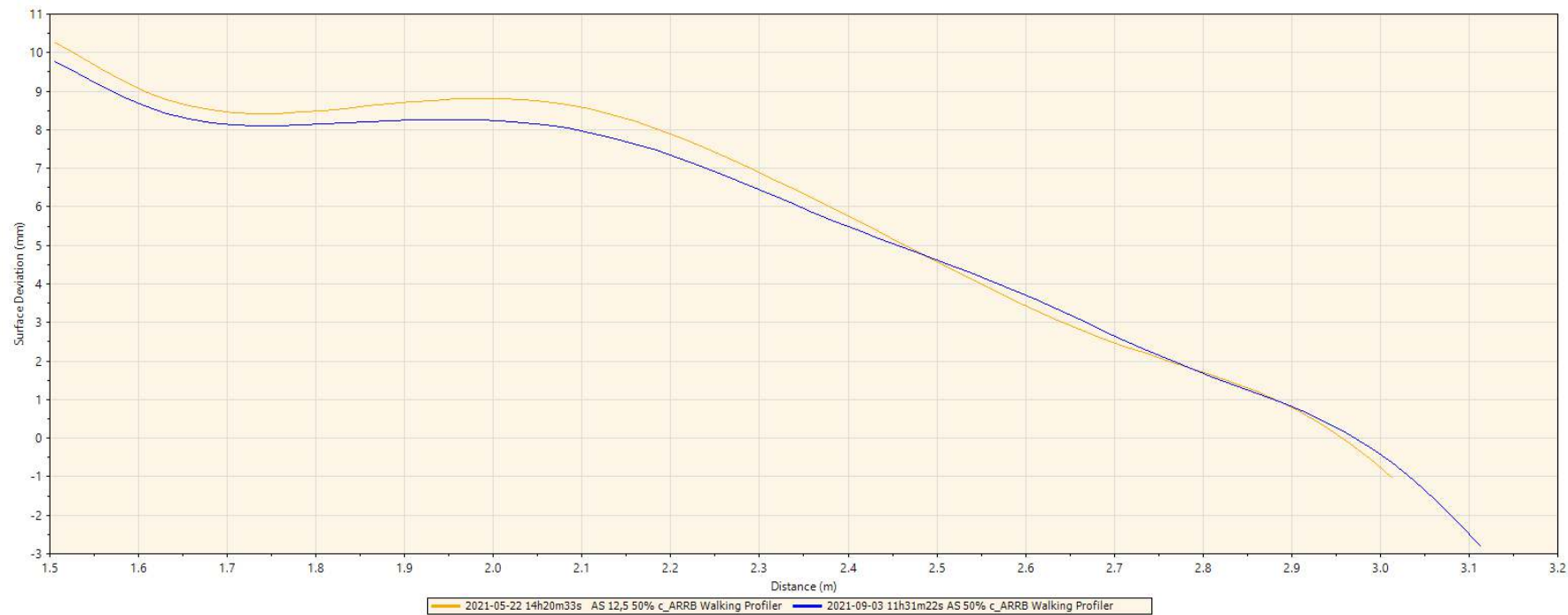
Εικόνα 31- Τροχαυλάκωση, ΤΡΟΠΟΠΟΙΗΜΕΝΗ ΑΣΦΑΛΤΟ ΜΕ ΤΡΙΜΜΑ ΕΛΑΣΤΙΚΟΥ ΚΑΙ ΜΕ 50% RAP - Σύγκριση αποτελεσμάτων
