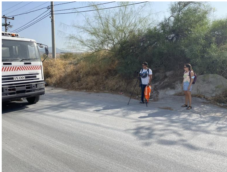
Εικόνα 12 - Ηχομέτρηση διερχόμενου φορτηγού
