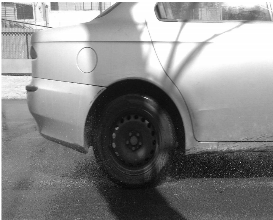
Εικόνα 7 – I.X. κινούμενο σε τροποποιημένη ασφαλτο με χρήση 30% RAP
