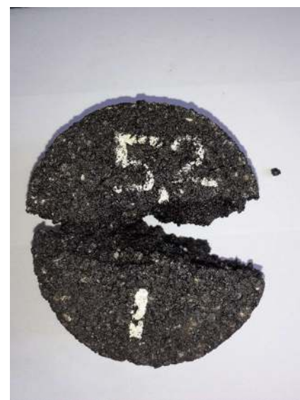
Εικόνα 2: Από αριστερά προς τα δεξιά: δοκιμή θλίψης, υδρεμποτισμός, κατεστραμένο δοκίμιο μετά από δοκιμή θλίψης
