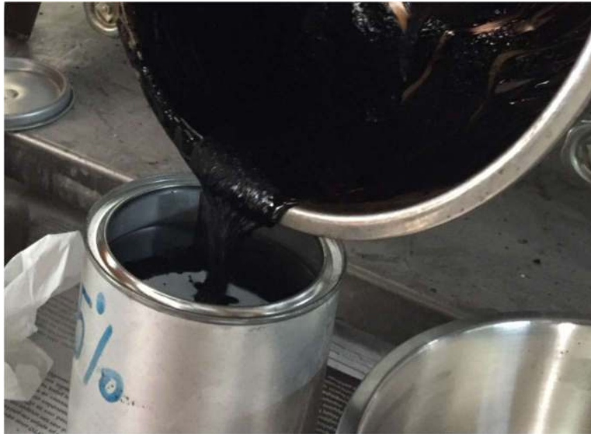
Εικόνα 1: Τροποποιημένη άσφαλτός με 5% πούδρα ελαστικού
