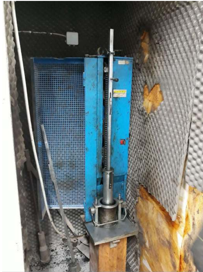
Εικόνα 8: Παρασκευή δοκιμών Marshall
