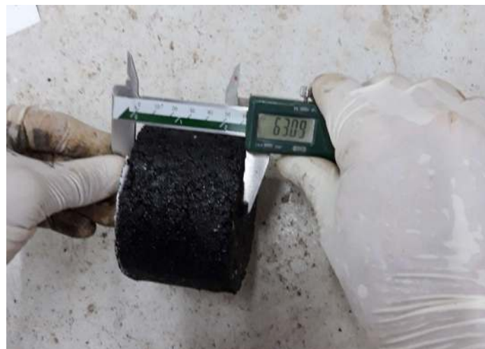
Εικόνα 9: Δοκίμιο Marshall τροποποιημένου ασφαλτομίγματος
