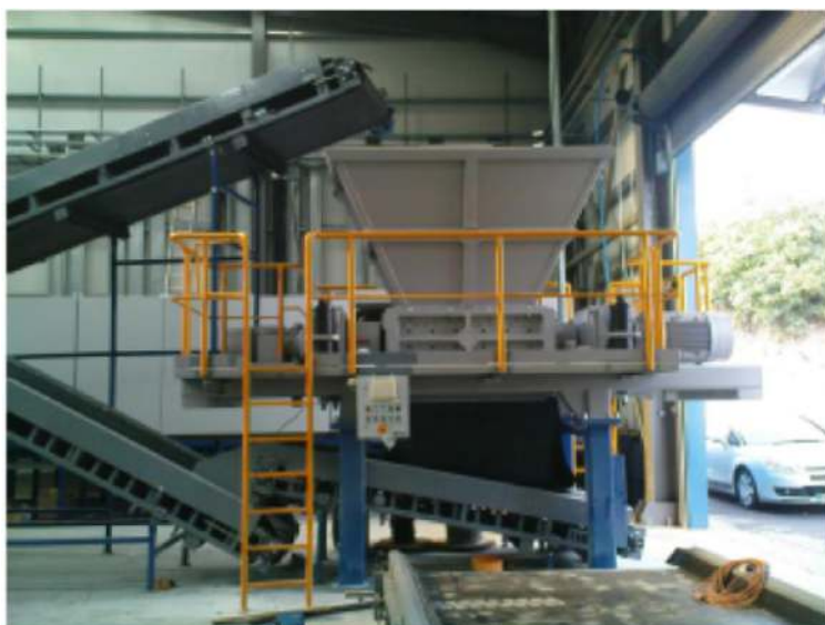
Εικόνα 1.2.1.: Θραυστήρας προτεμαχισμού, μηχανική φόρτωση χρησιμοποιημένων ελαστικών ή προτεμαχισμένων τεμαχίων ελαστικού με μεταφορική ταινία.
