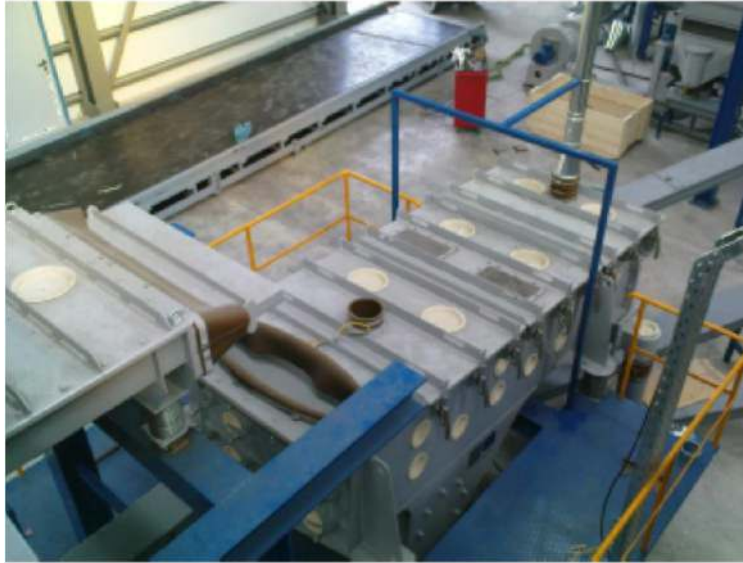
Εικόνα: Δονούμενο κόσκινο δευτεροβάθμιας επεξεργασίας, μηχανική φόρτωση τεμαχίων ελαστικών με μεταφορική ταινία.
