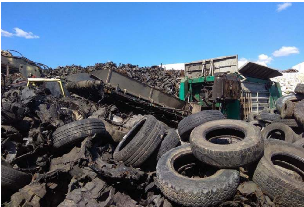
4: Τεμαχιστής: Τα ελαστικά των φορτηγών κομματιάζονται στο προαύλιο χώρο πριν την εισαγωγή τους στην παραγωγική διαδικασία
