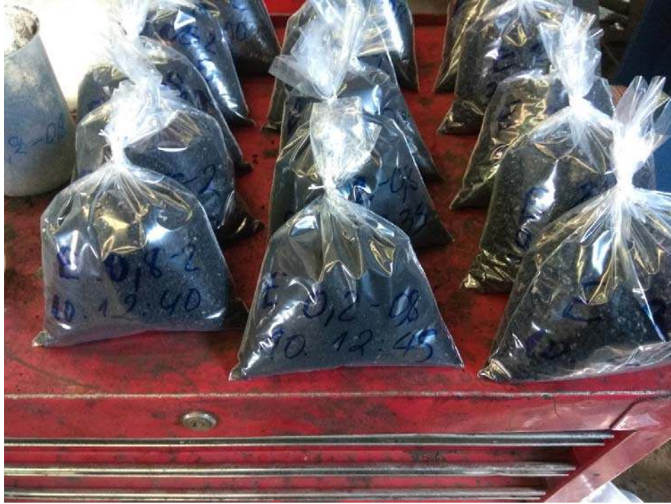
1: Δειγματοληψία των increments, περίπου κάθε 10 λεπτά
