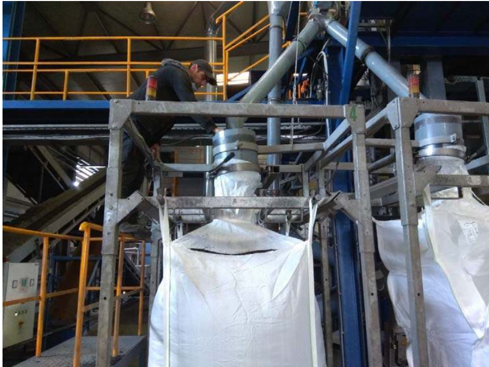
10: Δειγματοληψία των increments. Η δειγματοληψία πραγματοποιείται από σταθερό σημείο με χρήση δοχείου δειγματοληψίας. Το δοχείο δειγματοληψίας περνά από την ροή του υλικού κατά την πτώση του.
