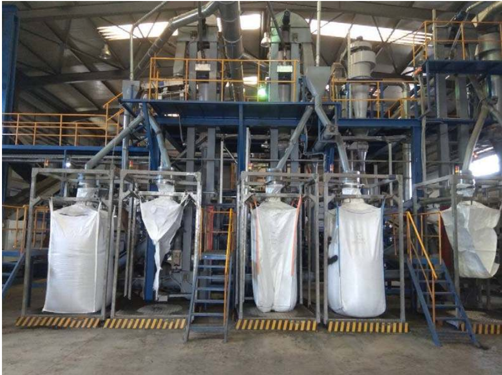
7: Παραγωγή τρίμματος, 3 γραμμές παραγωγής μία για κάθε κοκκομετρία. Συνολική παραγωγή περίπου 1,5 tn την ώρα
