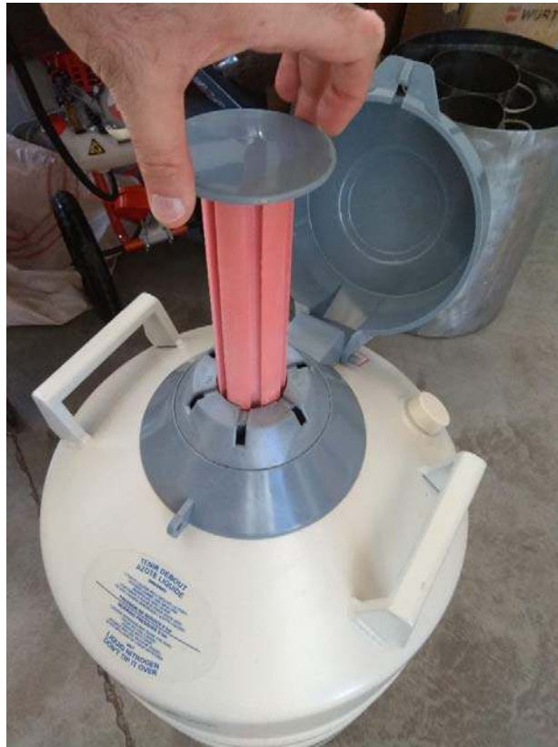
Εικόνα 4: Κρυογονική μέθοδος άλεσης στο εργαστήριο του ΕΚΕΤΑ (χρήση υγρού αζώτου)
