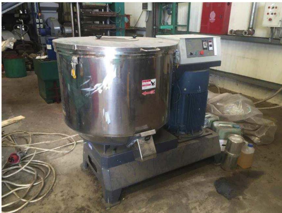
Εικόνα 1.: Μονάδα ανάμιξης και βαφής τρίμματος ελαστικού.
