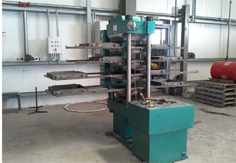
Εικόνα 2: Πρέσα βουλκανισμού παραγωγής τεχνητών πλακιδίων.
