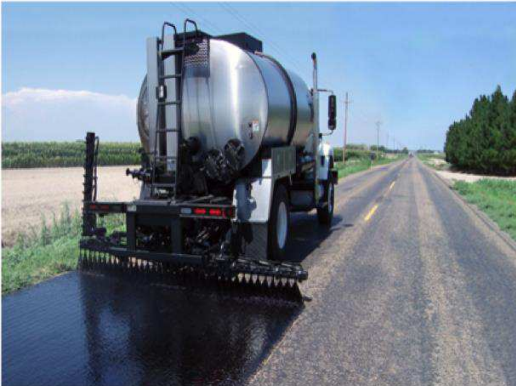
Σχήμα 4. Διανομέας ασφάλτου εν λειτουργία [7] .
